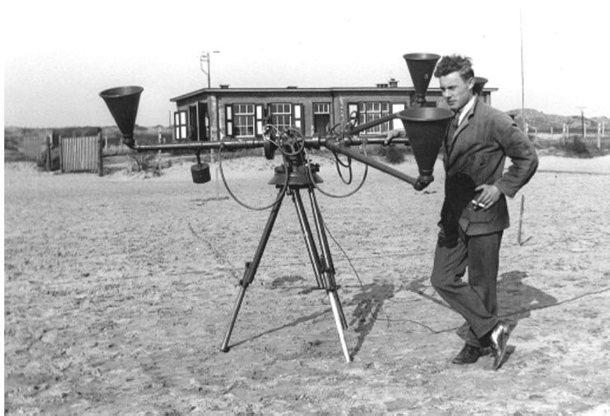
Doppelt Richtungshörer, manufacturer Askania, Germany
