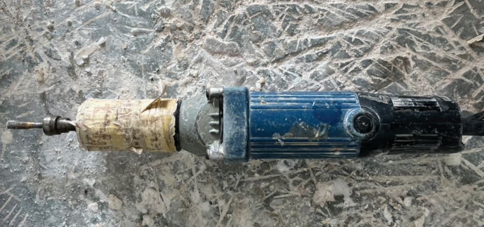
Fig 14.1: Die Grinder Machine
