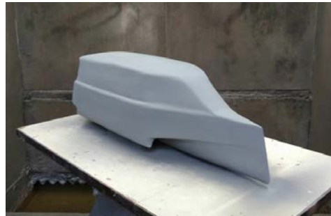
Img 68. Coat of primer
